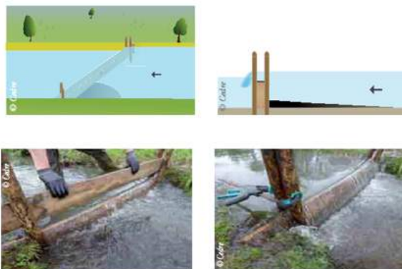
شکل ۴۳: شماتیک محدود سازی توسط یک بند با جریان روگذر (۲۵)
