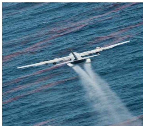
شکل ۷۶: استفاده از هواپیما برای پخش مواد پراکنده کننده بر روی لکه نفتی در آب دریا (۲)
