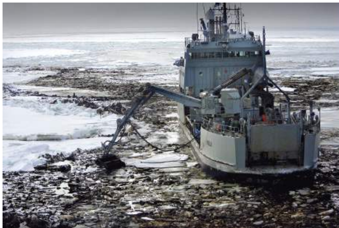
شکل ۵۸: رویه گیر (اسکیمر) بررسی در حال جداسازی لکه های نفت از یخ (۲)
