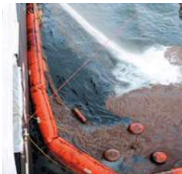
شکل ۵۹: اسکیم (رویه گیر) سرریز دار برای جمع آوری مواد نفتی (۲)
